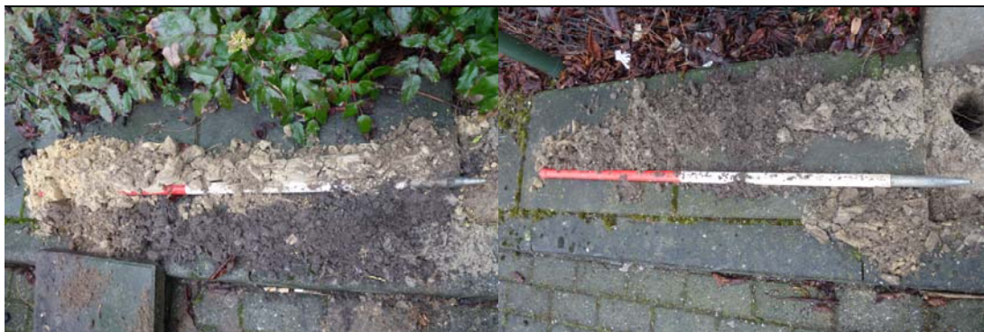
Figuur 3.3 Foto's van de opbouw van de profielboringen. Links: Diepe boring (tabel 3.2). Rechts: Ondiepe boring (tabel 3.3)
